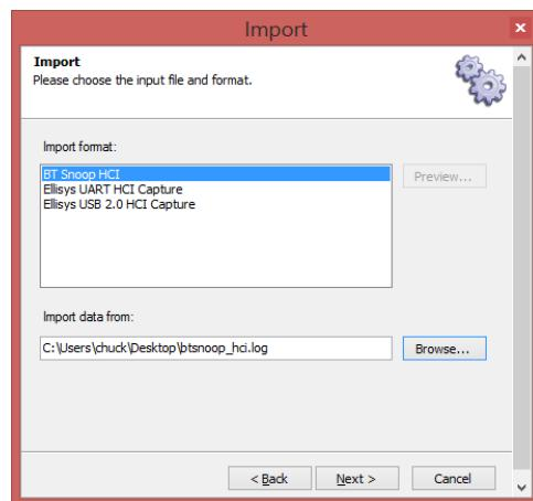
以下のスクリーンショットは、アナライザソフトウェアが携帯電話の BT Snoop ログファイルをインポートした後の状態です。また、赤枠、ハイライト部は、携帯電話とヘッドセットの間で確立されたリンクキーを示しています。このキーはアナライザソフトウェアによって保存され、携帯電話とヘッドセット間で行われる後続の通信の複合化に使用されます。
