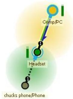
ヘッドセットと電話機の接続については、リンクキーが取得されているため、完全に復号化されています（Security ウィンドウに表示されています）。しかし、ヘッドセットと PC の接続は、リンクキーがまだ取得されていないため、暗号化されたままです。
